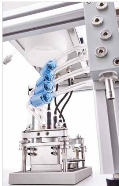
混合稀释之后，受试物质以 5 ml/分钟的流速通过等动力取样器进入染毒模組，多余空气被排出。
