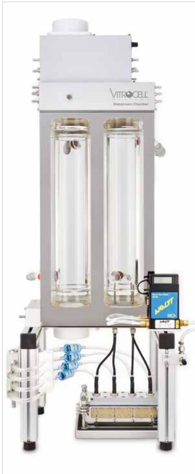
**仪器用途：**仪器设计精密，通过此仪器，空气物质与颗粒物从气体进样口进入染毒模組进样口。通道处有两个加热室，以确保气体物质的高效输送与均匀稀释。
