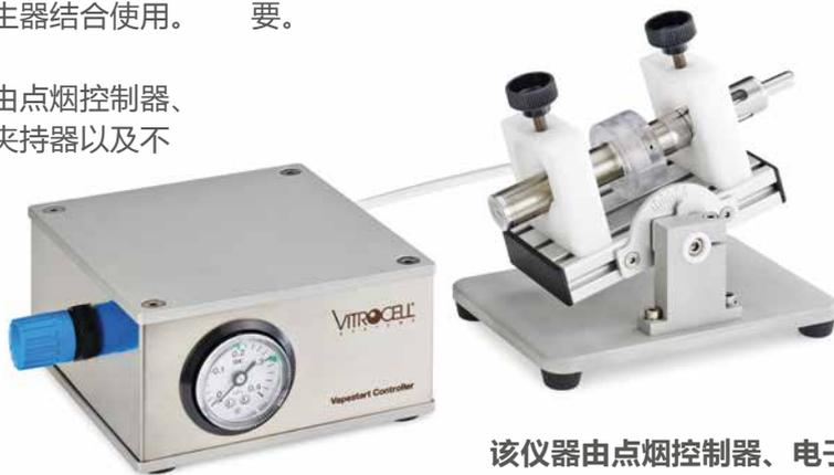
该仪器由点烟控制器、电子烟夹持器以及不同点烟装置组成
